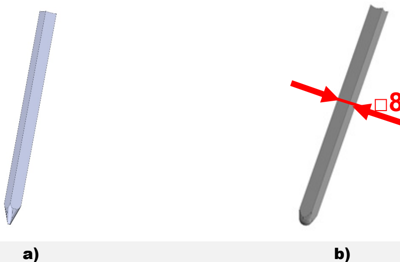
Rys. 9. Przedstawienie różnic w deformacji wyciskanych wyprasek a) wypraska Zn99 służąca za wypraskę wypychającą zalegającą wypraski miedzianej b) prawidłowa wypraska Zn99 (reprezentuje serię pięciu wykonanych wyprasek)
