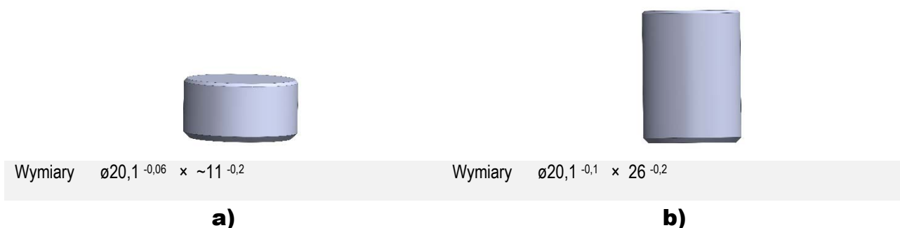
Rys. 7. Wstępniaki dla wyciskania w przyrządzie WWKn: a) wstępniak rozpoczynający i wypychający, b) wstępniak właściwy
