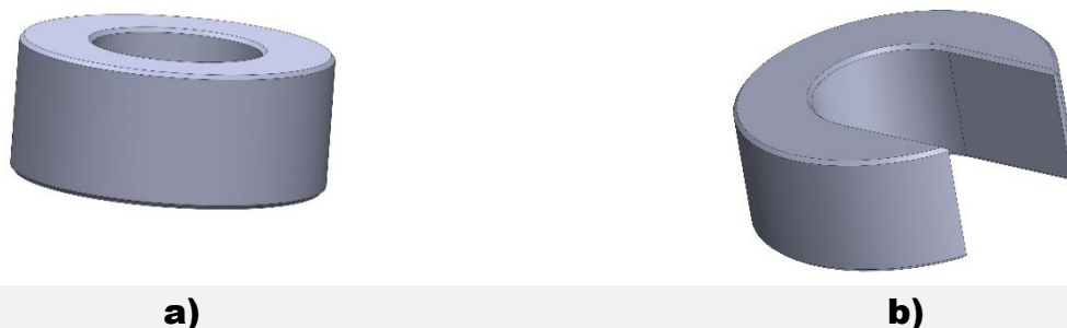
Rys. 13. Dwie podkładki dystansowe regulujące wysokość odpowiedniego zamknięcia przyrządu (uzyskanie efektu twardego zderzaka w dolnym punkcie operacji): a) podkładka środkowa uzupełniająca, nawlekana na stałe na słup prowadzący, b) wymienna podkładka dystansowa w kształcie podkowy
